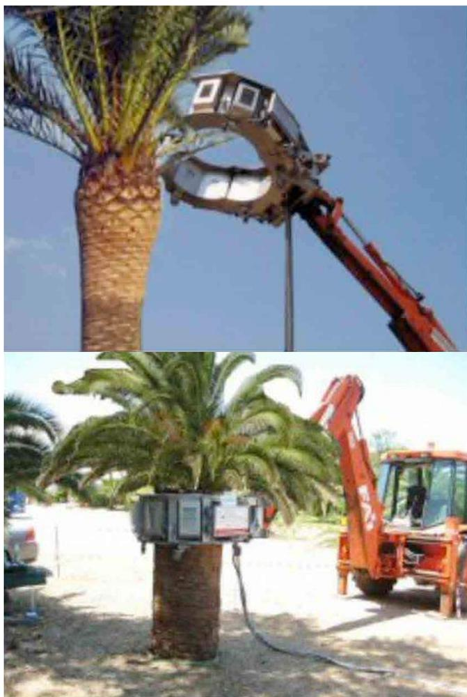
**Figura 11.** Equipo usado para la aplicación de la técnica de bioacústica (ECOPALM, s/a).
